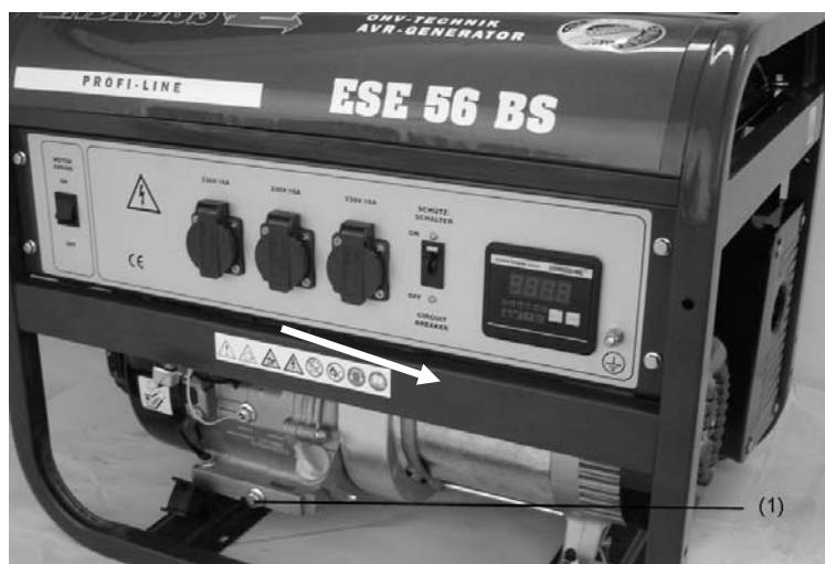
Рис. 4.4: Удаление винта для слива масла
